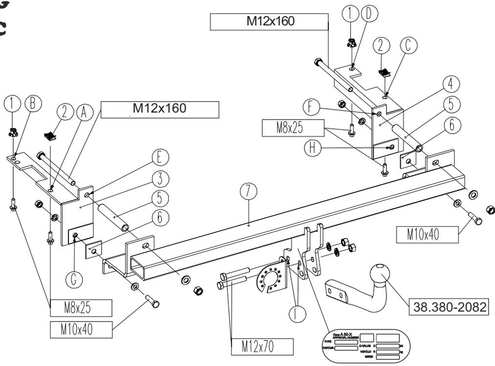
Fitting instruction Szerelési utasítás Instruzioni di montaggio Monteringshandledning Instruction de montage Montageanleitung
