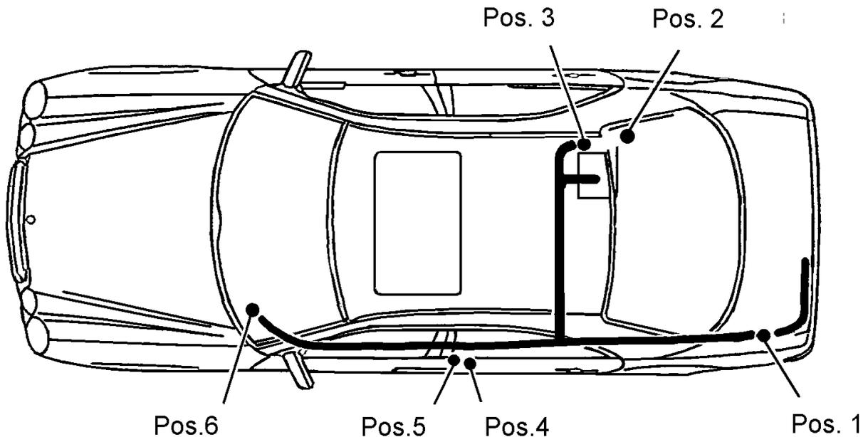
Die auf der obigen Abb. dargestellte Verlegung des Leitungssatzes ist bei den Modellen W 210 Limousine und S 210 T-Limousine (Kombi) identisch!
